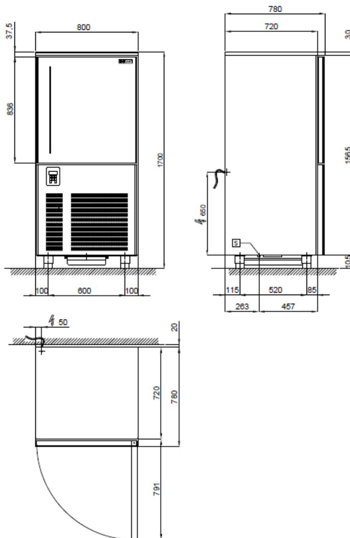
Branchement électrique: 3x1.5 mm<sup>2</sup> fil avec fiche Schuko; L=4000 mm
